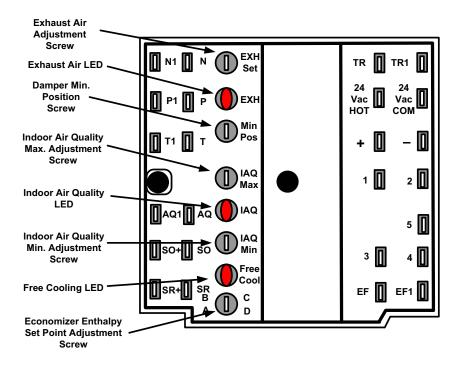
FIGURE 8 - HONEYWELL ECONOMIZER CONTROL W7212
