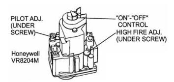
FIGURE 19 - TYPICAL SINGLE STAGE GAS VALVES
