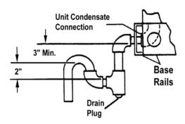
FIGURE 1 - RECOMMENDED DRAIN PIPING
