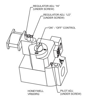
FIGURE 20 - TYPICAL 2 STAGE GAS VALVES
